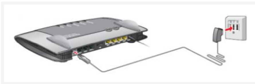
Abb.: FRITZ!Box per DSL-Kabel mit IP-basierten DSL-Anschluss verbinden
