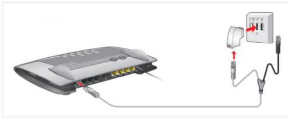
Abb.: FRITZ!Box per DSL-Adapter mit DSL-Anschluss verbinden
